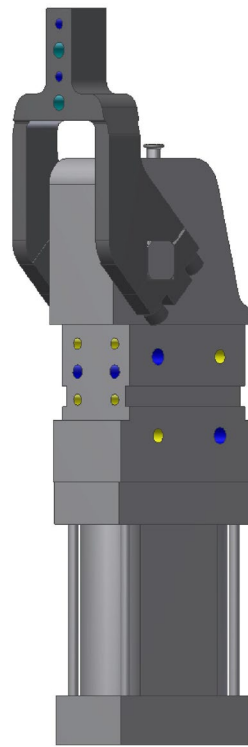
Clamp arm position 2: „Clamp type2“ 40 A10 ...2 50 A10 ...2 63 A10 ...2 80 A10
