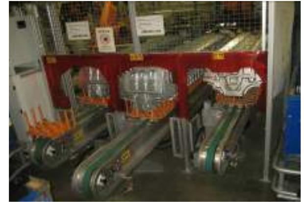
**Mehrstranganlage mit kopfseitiger Beladung**
