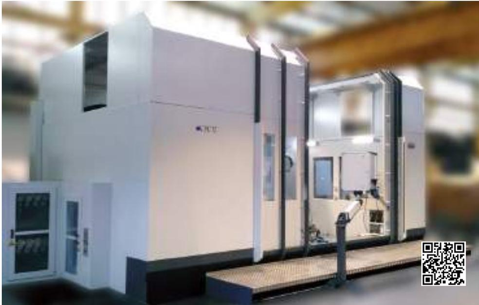
**E**XPERT-TÜNKERS investiert in ein neues Großbearbeitungszentrum, um die Fertigungskapazitäten und Bearbeitungsmöglichkeiten weiter auszubauen. Mit der „AXA VPC 2800U“ ist es möglich, Drehtische mit einem Durchmesser bis zu 3m und Hubsäulen bis ca. 4m Länge zu fertigen. Die Maschine selbst hat ein Gewicht von 52t und steht in einer Fundamentgrube aus über 100t Stahlbeton mit einer Deckenstärke von ca. 1,6m. Trotz der Größe können so Toleranzen von 0,01 mm garantiert werden.
